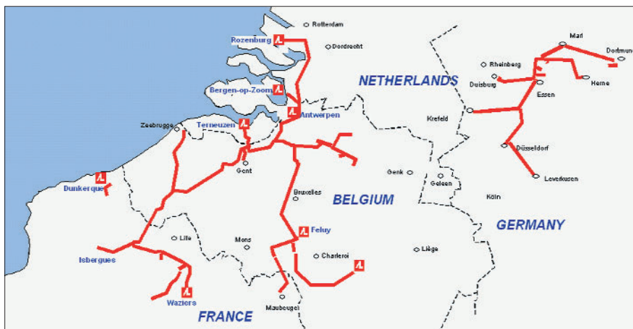
Fig. 1 : Le plus grand réseau de transport d'hydrogène par canalisation en Europe du Nord, exploité par Air Liquide (source Air Liquide)
