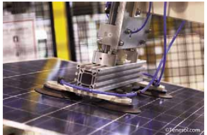
Ténésol, Toulouse - Usine de production de modules photovoltaïques
